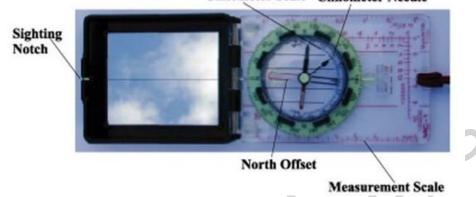
Clinometer Scale Clinometer Needle
