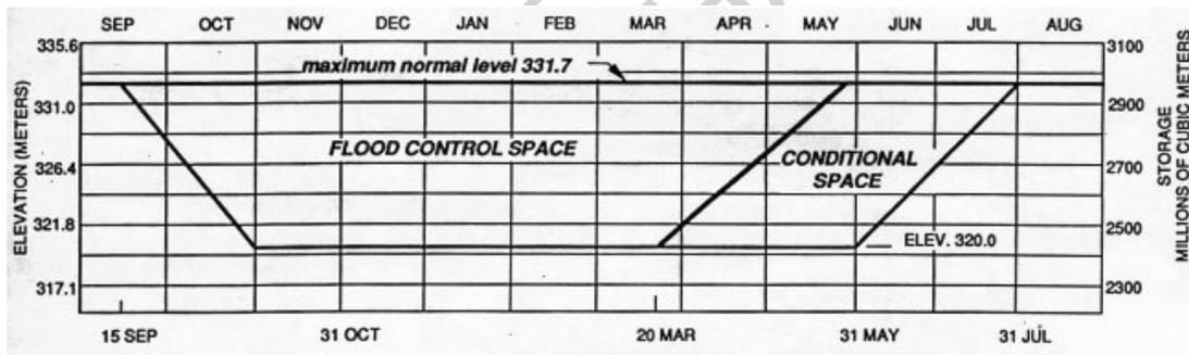
FLOOD CONTROL OPERATION AND UTILIZATION OF FLOOD CONTROL SPACE
